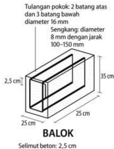
Gambar 5: Pembesian balok dimensi 25/25
