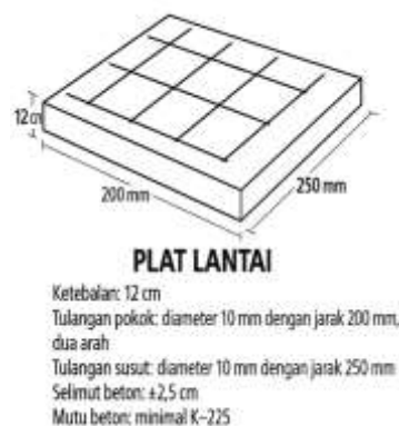
Gambar 6: Pembesian plat lantai dengan tebal 12 cm
