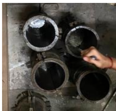
Gambar 4: Cetakan silinder baja 15 x 30 cm
